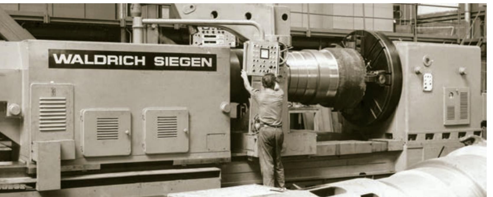
Početkom sedamdesetih godina u novoizgrađenim halama Tvornice dizelskih motora instalirani su najsvremeniji veliki alatni strojevi za obradu dijelova motora. Na ispitnoj stanicji ispituju se i montiraju dizelski motori 3. MAJ - SULZER poput motora 6 RND 90 od 17.400 Ks (na slici desno)
