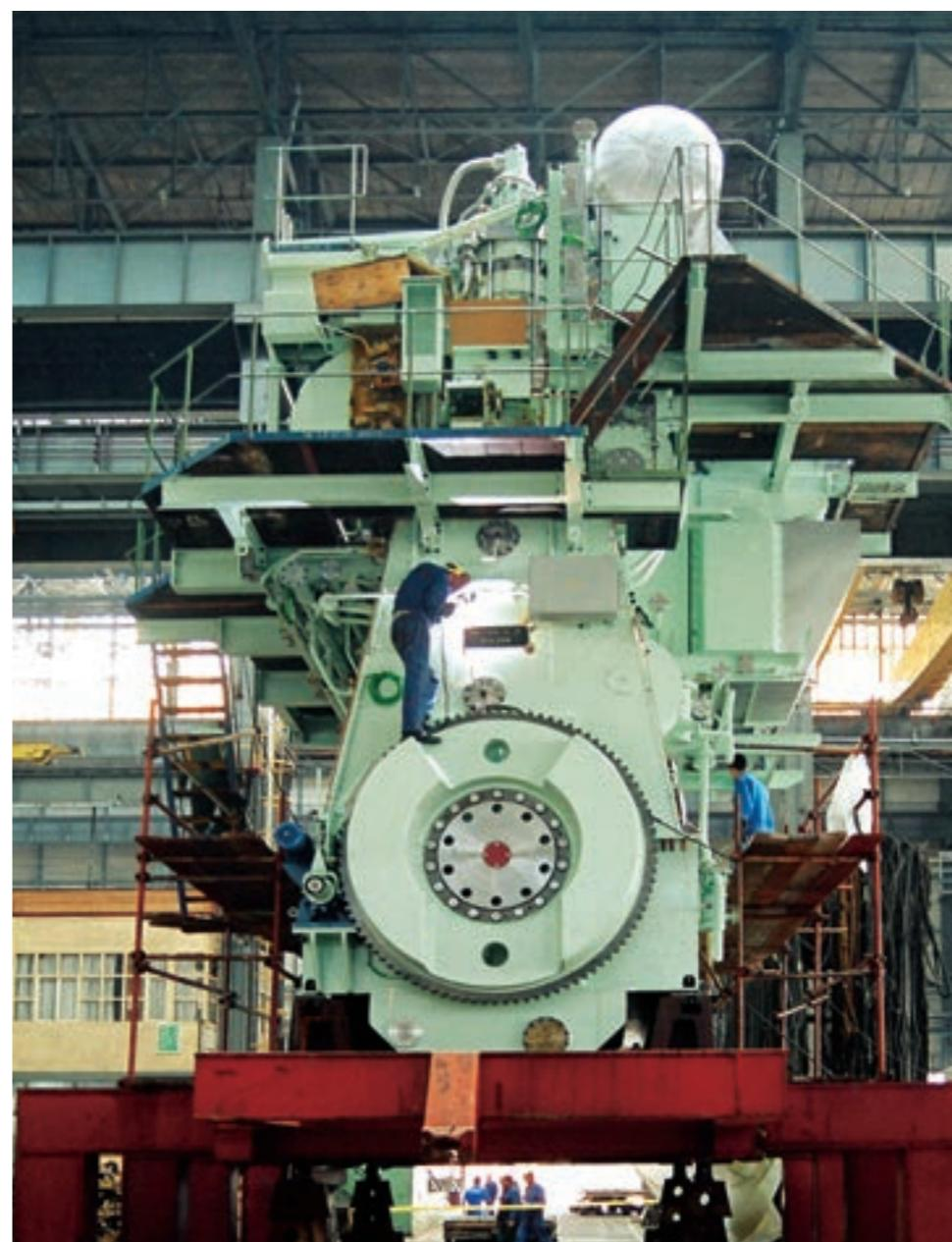
Dizelski motor 3. MAJ - SULZER tipa 7 RTA 48 T - B spreman za ugradnju na novogradnju 691.
